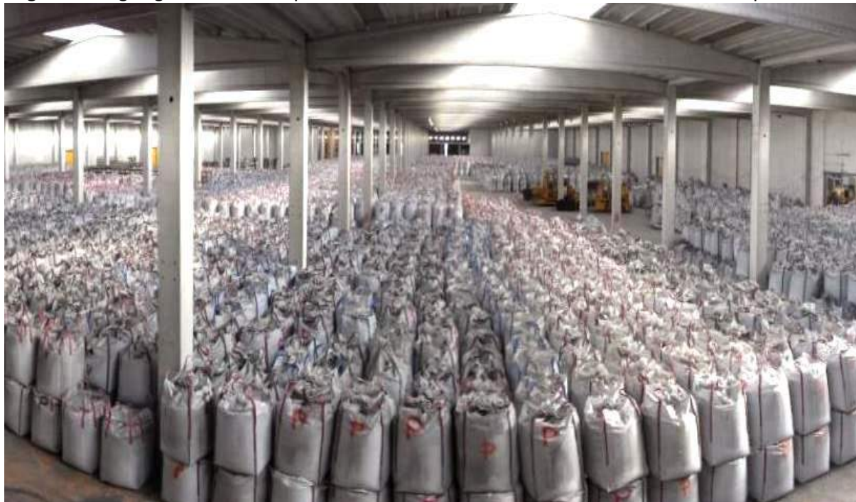
Figura 60: Big Bags contenenti le polveri di abbattimento fumi stoccati all'interno del capannone A2
