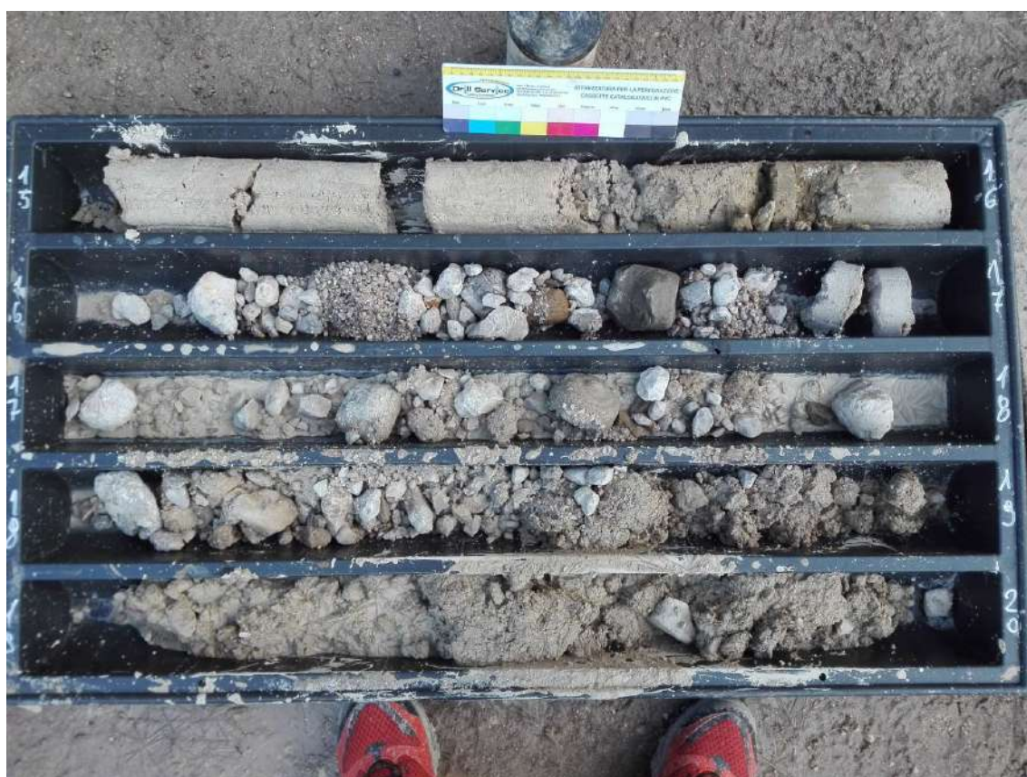
FOTO 4: Cassette catalogatrici S 01-DH 01, profondità da 15,0 a 20,0 m.
