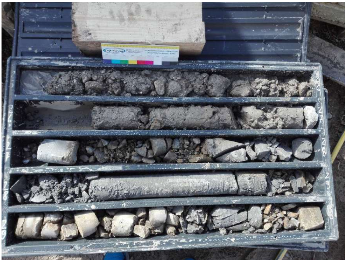
FOTO 6: Cassette catalogatrici S 01- DH 01, profondità da 25,0 a 30,0 m.
