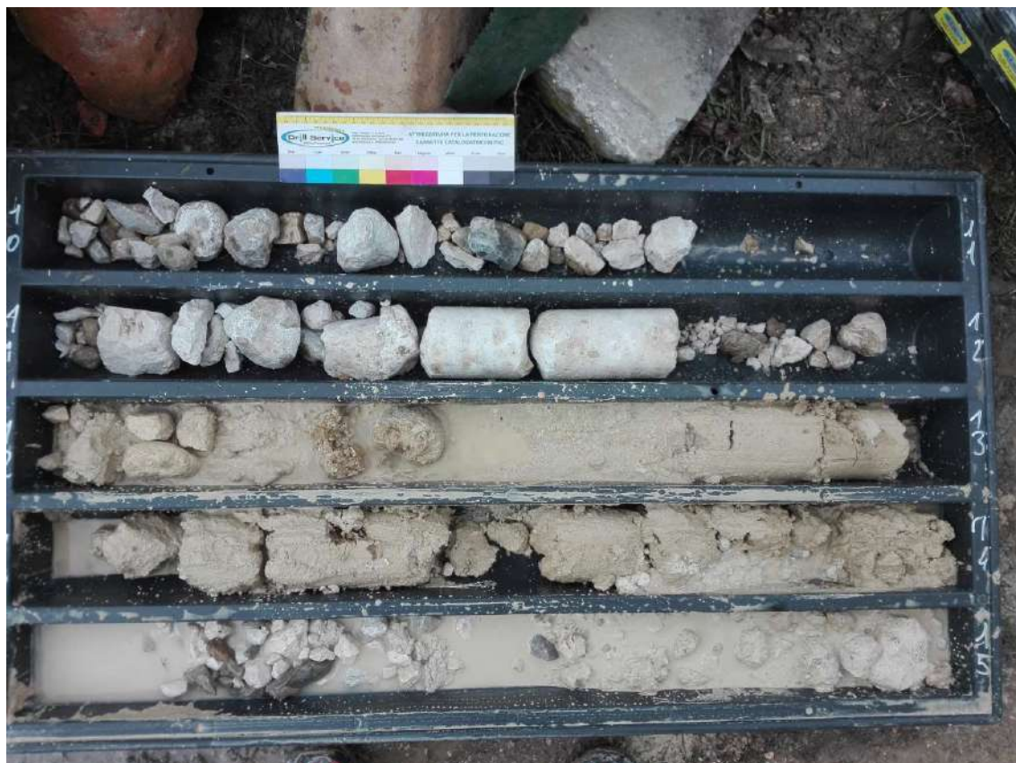
FOTO 3: Cassette catalogatrici S 01-DH 01, profondità da 10,0 a 15,0 m.
