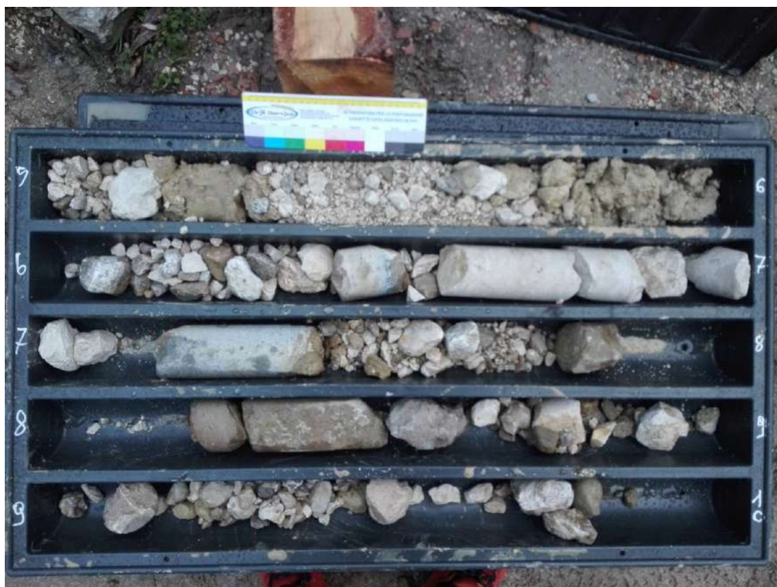
FOTO 2 : Cassette catalogatrici S 01- DH 01, profondità da 5,0 a 10,0 m.
