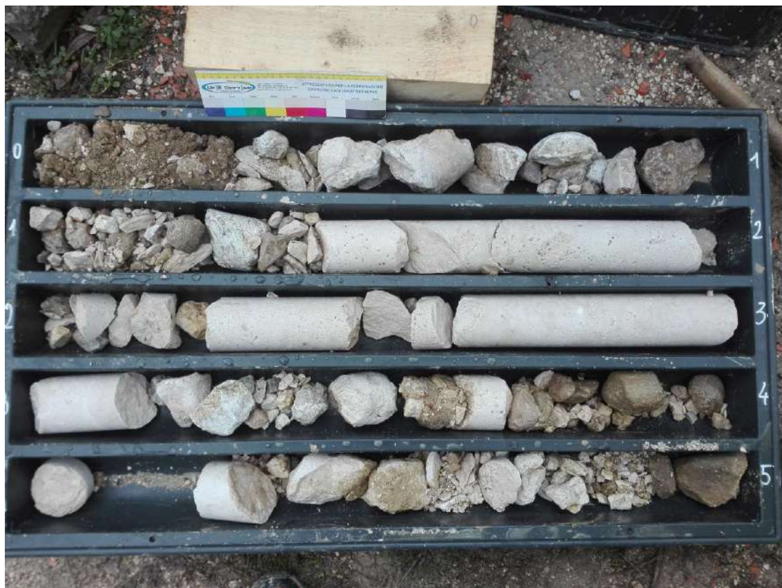
FOTO 1 : Cassette catalogatrici S 01- DH 01, profondità da 0,0 a 5,0 m.
