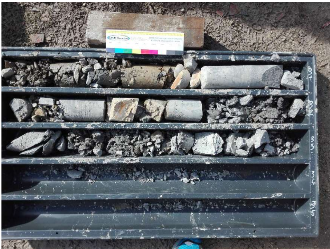
FOTO 7 : Cassette catalogatrici S 01- DH 01, profondità da 30,0 a 33,0 m.
