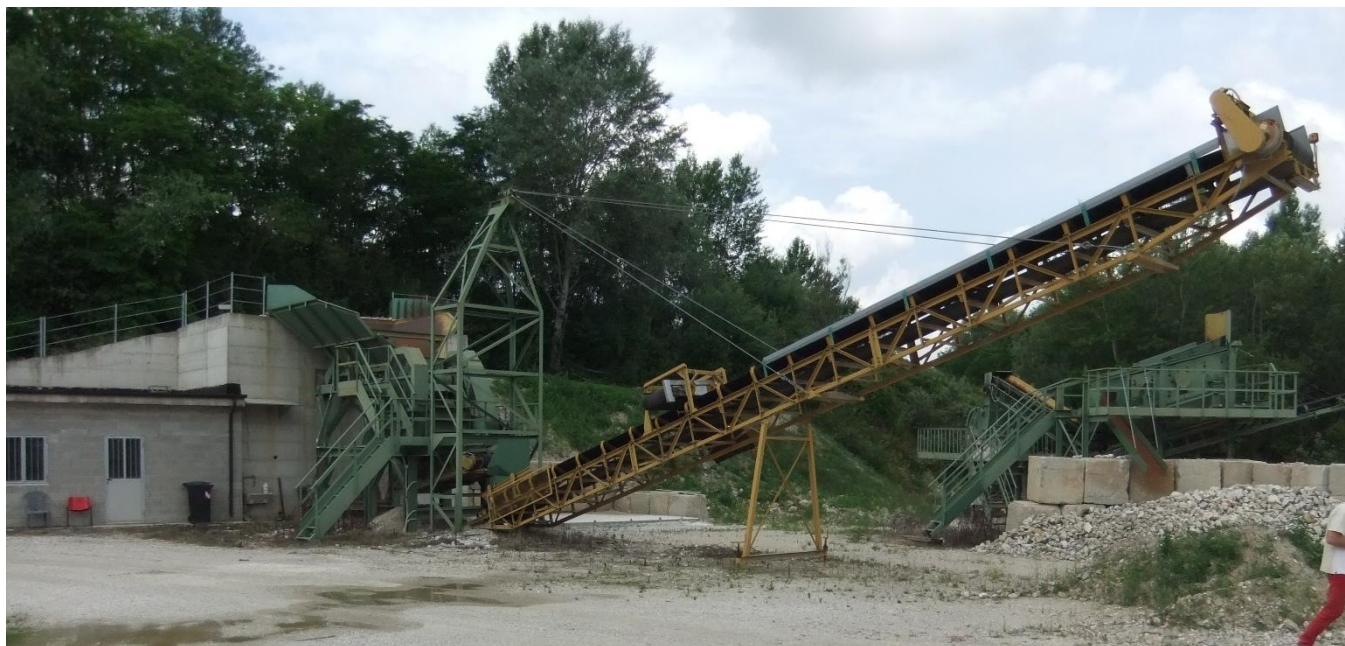
Figura 5 – Frantumatore e nastro trasportatore con elettrocalamita della Beani Annibale SRL
